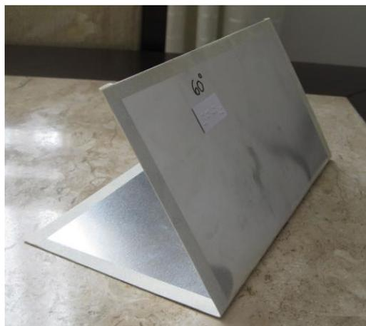
Figura 10: Chapas de alumínio dobradas segundo ângulo indicado.
